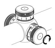
Abb. 15: Korrektur eines Linksschusses
