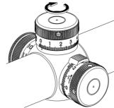
Abb. 14: Korrektur eines Tiefschusses
