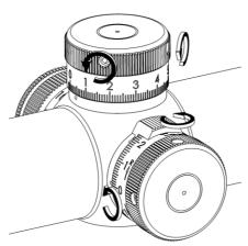
Abb. 13: Nullen des Zielfernrohres - Lösen der Schrauben
