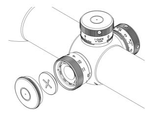
Abb. 6: Batteriewechsel
