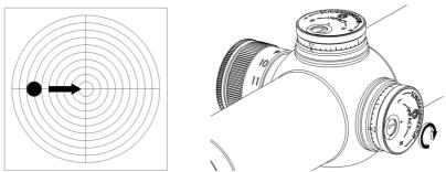
Abb. 10: Korrektur eines Linksschusses
