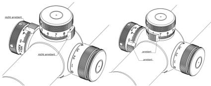
Abb. 12: Arretierung der Türme: verstellbar und arretiert
