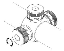
Abb. 5: Bedienung der Beleuchtung
