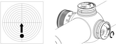
Abb. 9: Korrektur eines Tiefschusses
